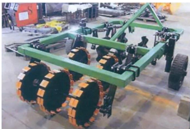
Экспериментальная установка для подготовки почвы под посев мелкосемянных культур с макетными образцами дисковых и катковых рабочих органов
