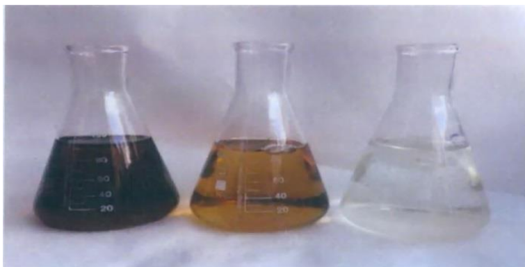
Изменение цветности сахарного сиропа в результате электродеионизации (слева направо: сироп до обработки, деминерализованный сироп, концентрат)
