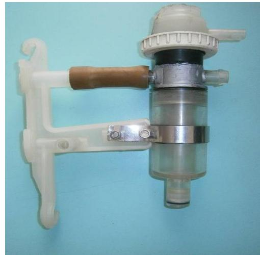
Коллектор доильного аппарата (слева) и устройство для автоматического отбора первых порций молока (справа)
