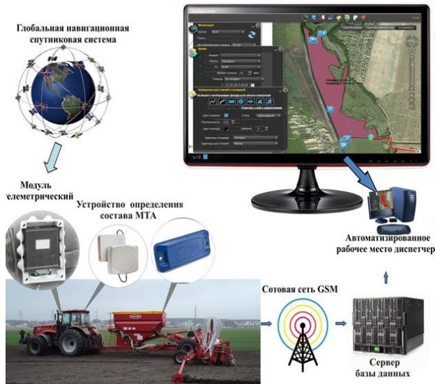
*Автоматизированная система эксплуатационного контроля МТА*
