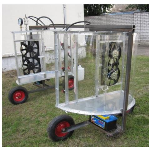
*Макетный образец туннельного устройства садового шатрового опрыскивателя*
