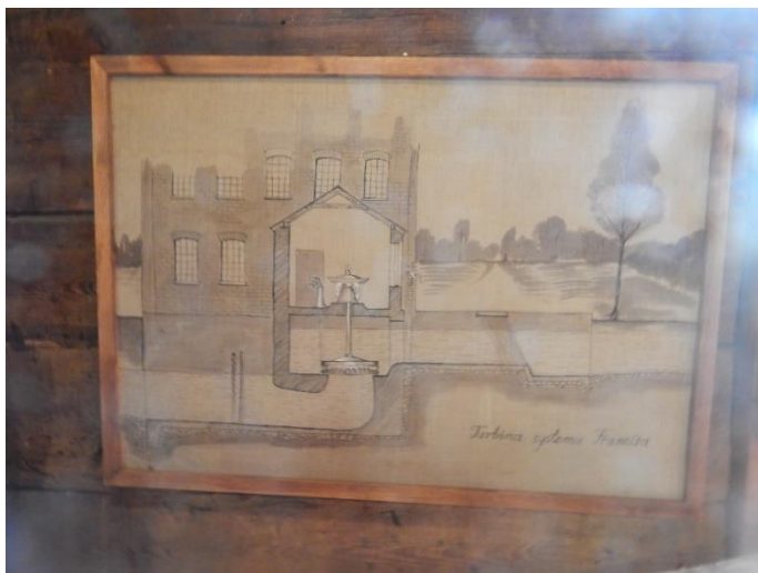
Малюнак 1 – Схема млына і турбіны сістэмы Френсіса ў Цеханавецкім музеі. Рэспубліка Польшча, 2019 г.
