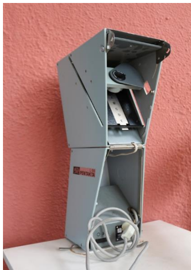
Рисунок 6 – Проектор для чтения микрофиш «Pentakta L-100» от «Carl Zeiss»
