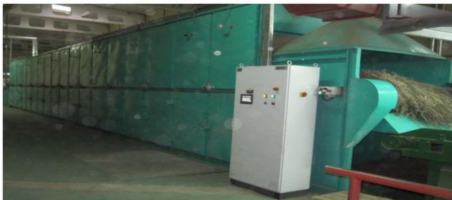
*Опытный образец машины сушильной в действующей линии переработки льна на филиале «Кормянский льнозавод» ОАО «Гомельльён»*
