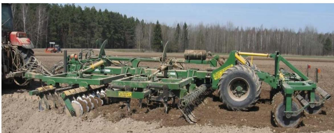
*Агрегат почвообрабатывающий многофункциональный АПМ-6А*
